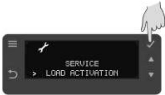
Abaixo está uma lista de cargas que podem ser ativadas, através dos botões UP e DOWN ( 4 e 5 ), e seus critérios exigidos. Cada uma das cargas possui um timeout de segurança aplicado para reduzir o risco de desgaste dos componentes.
