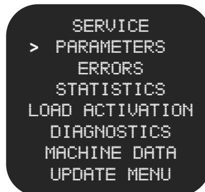
Pressionando os botões UP e DOWN (4 e 5), vá até SERVICE Lists e pressione o botão SELECT (2). Pressionar o botão BACK (7) levará a lavadora para o modo de configuração e pressionar o botão BACK (7) novamente levará a lavadora para o modo normal.
