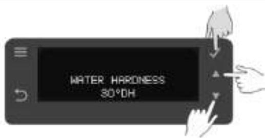
**PASSO 6:** Este passo é exclusivo para máquinas de lavar com descalcificador de água externo. Ajuste a capacidade do tratamento de água em litros, com os botões Para cima e Para Baixo (5 & 6). Consulte os dados do fornecedor para o descalcificador de água externo.
