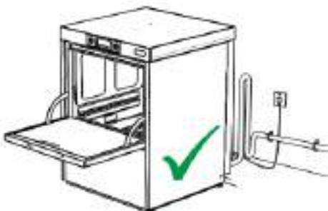
A máquina de lavar deve ser colocada num local que permita a instalação das ligações elétricas, de abastecimento de água e de águas residuais (►4.3).
