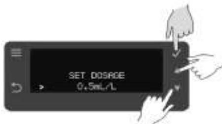
Ajuste a dose de abrillantador com o botão (4) e (5), em função da concentração em mililitros por litro de água (ml/l). Confirme a seleção, com o botão Selecionar (2). Predefinido para 0,1ml/l.
