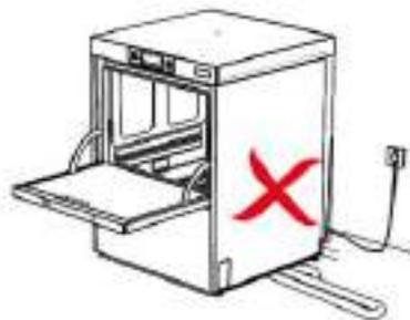
Ao posicionar a máquina de lavar, certifique-se de que a entrada de água, os tubos de produtos químicos e os tubos de descarga não estão dobrados ou esmagados. Certifique-se também de que a máquina de lavar não se apoia em nenhum dos tubos de admissão/cabos de alimentação.
